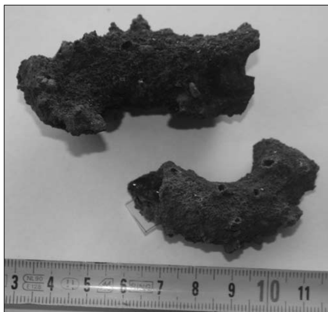
Fig. 2. Folgorite (record 7 in Tab. 1) prodotta dalla fusione di sabbie silicoclastiche di origine vulcanica (SW di Sisters - Oregon, USA).
